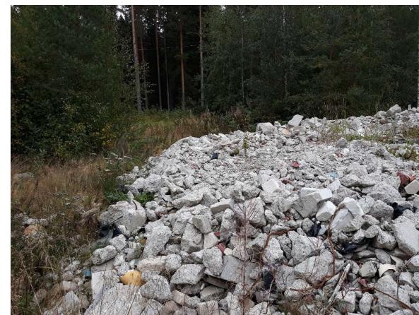
Laadultaan mara-asetuksen vastaista betonijätettä
