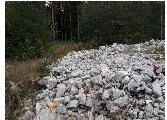
Laadultaan mara-asetuksen vastaista betonijätettä
