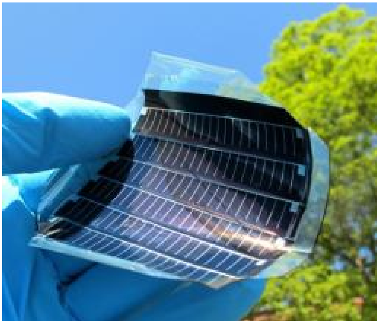
KUVA 12. Taipuisa kadmiumtelluridi (CdTe) -moduuli, jonka hyötysuhde on 13,8 %.
