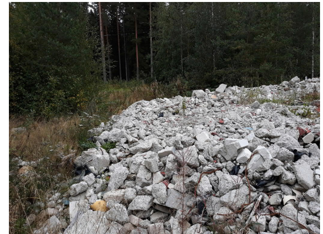
Laadultaan mara-asetuksen vastaista betonijätettä
