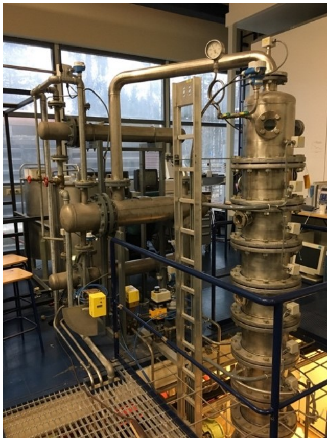
Kuva 4: Teollisen mittakaavan kaksikerroksinen alkoholitislausprosessi (Kolonne)
